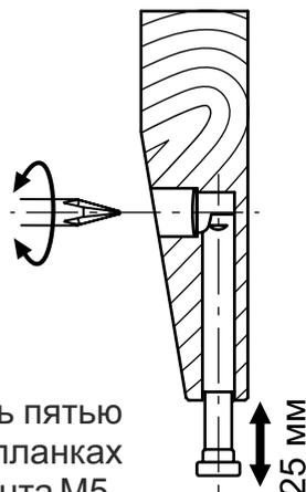
Стенки вертикальные боковые 02 оборудовать пятью монтажными планками Intermat. На монтажных планках Intermat закрепить адаптеры 22 мм с помощью винта M5.
