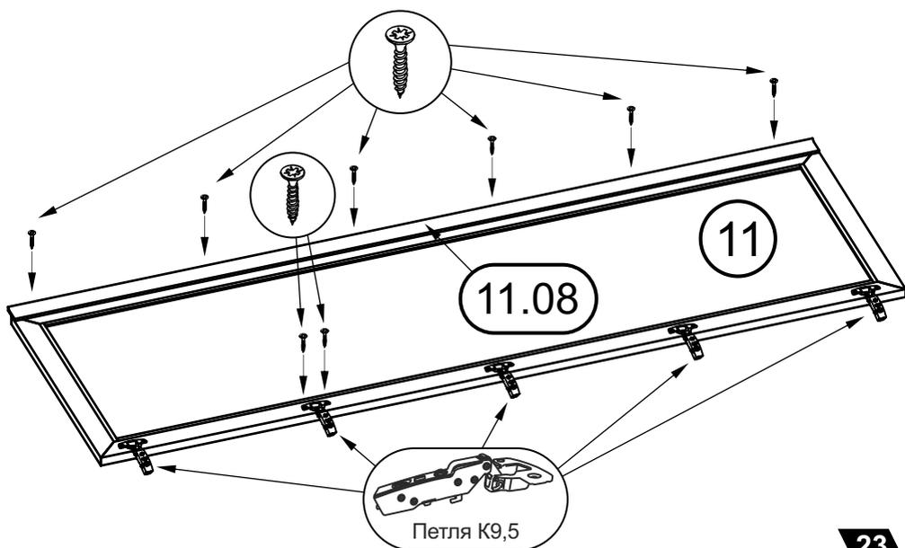
На шкаф установить двери. Отрегулировать согласно приведенной ниже схемы. Выровнять фасад по высоте. При необходимости отрегулируйте опоры.
