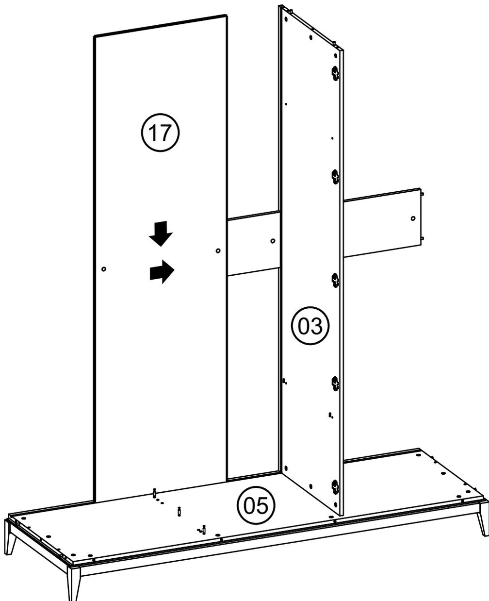
Установить стенку вертикальную среднюю 04 отверстиями на соединительные винты цоколя 05, при этом шканты стенки средней 04 должны войти в отверстия цоколя 05, стенка задняя 17 - в паз стенки средней 04.
