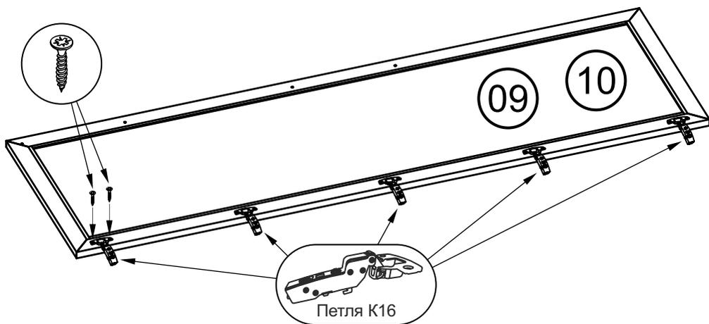
Дверь 11 осторожно уложить на прокладочный материал и установить четырехшарнирные петли К9,5. Закрепить петли на двери при помощи саморезов 4x16.
