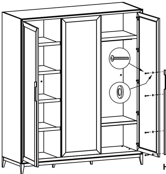
На двери установить ручки. Закрепить ручки при помощи винтов 4x30. При необходимости с тыльной стороны двери можно установить по одной металлической шайбе.
