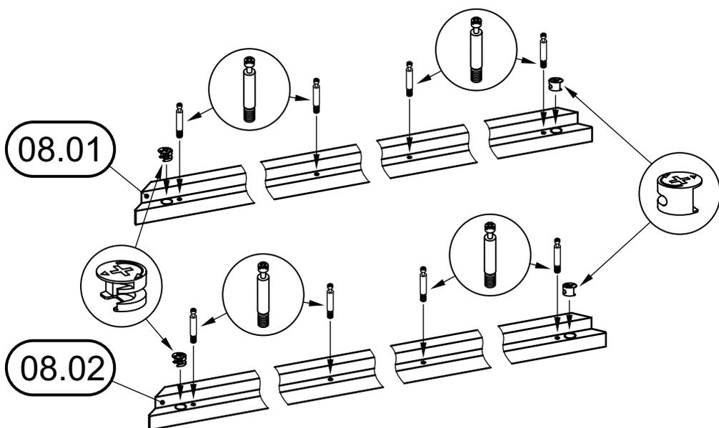
Бруски рамы горизонтальные 08.01 и вертикальные 08.02 собрать между собой при помощи угловых штоков эксцентрика. Зафиксировать детали при помощи эксцентриков.
