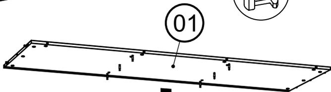
Приставить стенку верхнюю горизонтальную 01 соединительными винтами к отверстиям стенок вертикальных средних 03 и 04, обеспечив вхождение фурнитуры в отверстия сопрягаемых деталей, а задних стенок в паз горизонтальной стенки 01.
