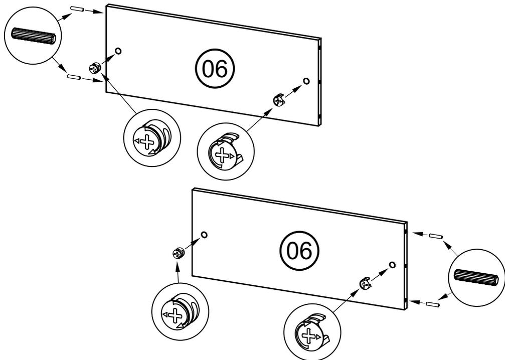
Стенку соединительную 06 оборудовать двумя эксцентриками.
