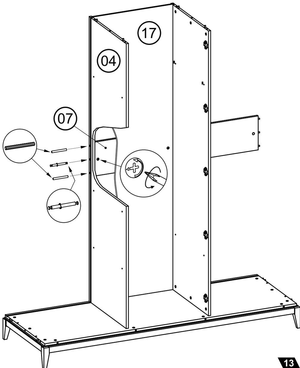
Установить стенку жесткости боковую 06 отверстиями на шток двусторонний и шканты 8x60 стенки вертикальной средней 04, закрепить стенку жесткости боковую 06 к стенке вертикальной средней 04 при помощи эксцентрика.
