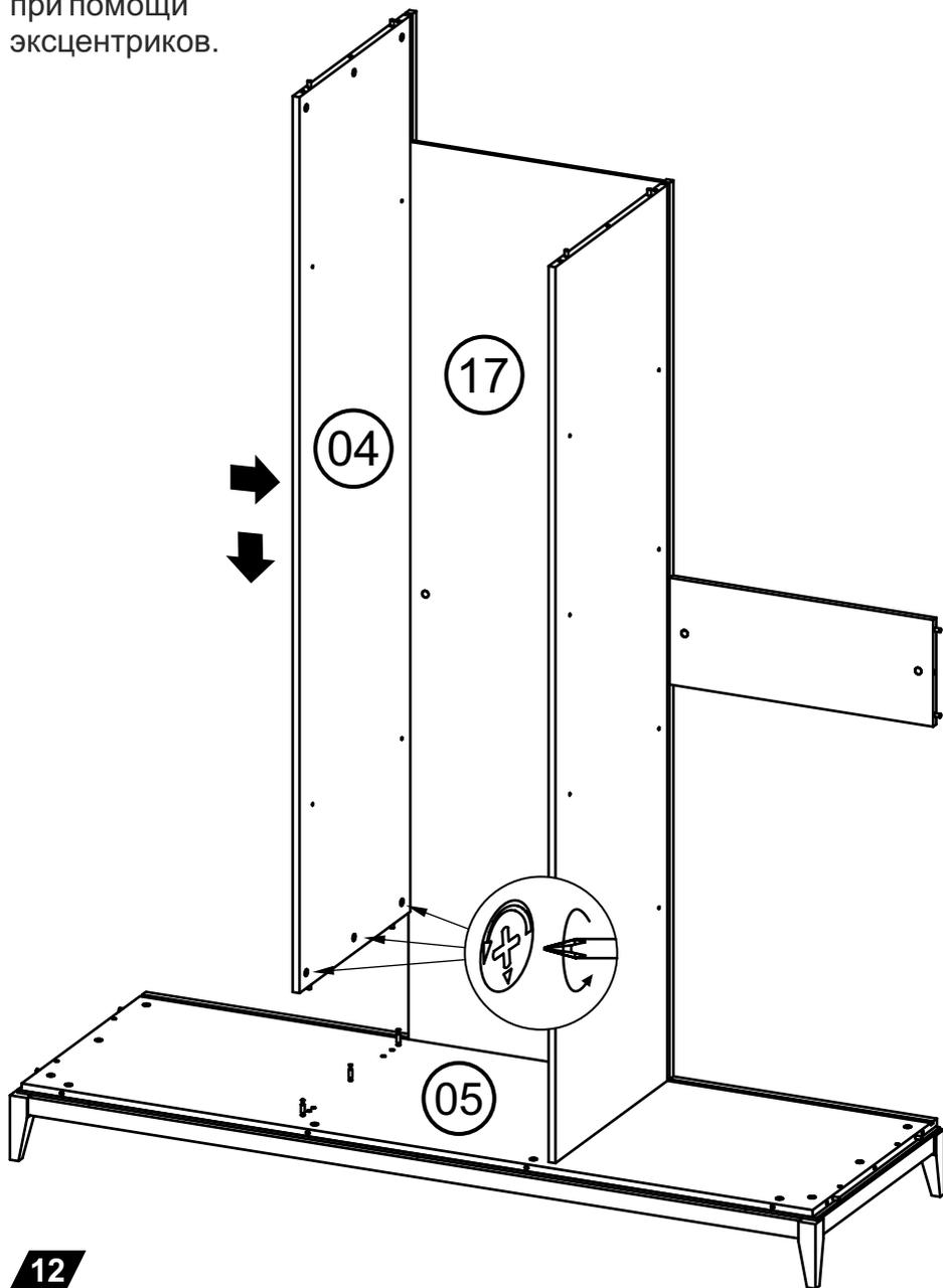
В среднее сквозное отверстие у задней кромки стенки средней 04 вставить длинной частью шток двусторонний и зафиксировать эксцентриком со стенкой жесткости средней 07. Фиксация эксцентрика осуществляется через отверстия в задней стенке 17
