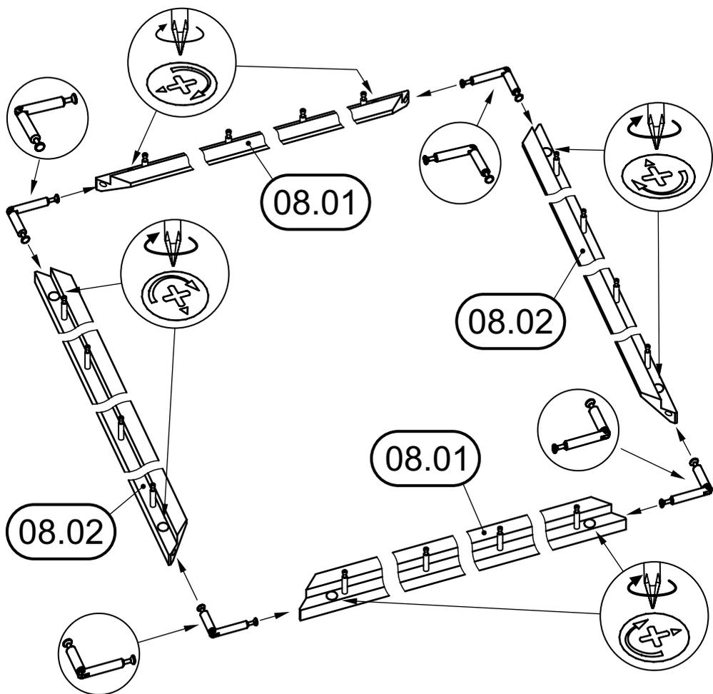
Установить раму в сборе соединительными винтами в отверстия на стенке горизонтальной 01, стенках вертикальных боковых 02 и цоколе 05.
