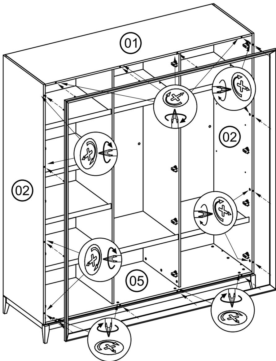
После установки рамки, все отверстия и крепежные элементы закрыть пластиковыми заглушками.
