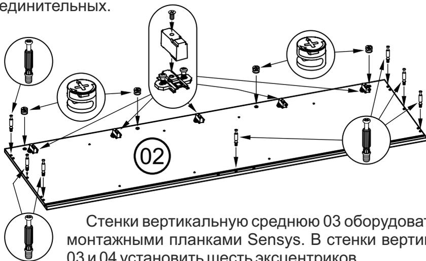
Стенки вертикальную среднюю 03 оборудовать пятью монтажными планками Sensys. В стенки вертикальные 03 и 04 установить шесть эксцентриков.
